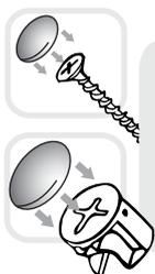
Al finalizar el ajuste de los conectores, proceda a poner las tapas adhesivas y en las cabezas de los tornillos de los chazos /
