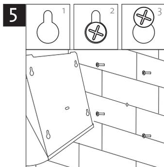
**5** Ensamble el dispensador en los cuatro tornillos de la pared de arriba hacia abajo tal como lo indica la imagen
