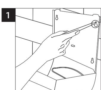
**1** Destape el dispensador por la parte posterior. Ubique el dispensador de toallas en la pared donde quedará instalado y marque con un lápiz la huella de los 5 orificios.
