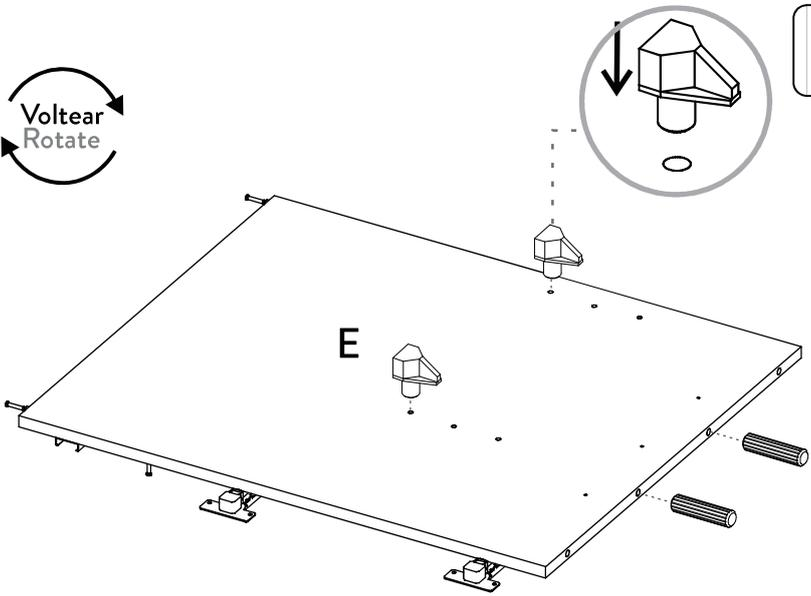
Si desea instalar el Horno, no ubique los dos (2) soportes de entreaño móvil en este paso.
