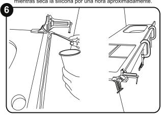
Proteja el piso antes de realizar la aplicación de la resina. Aplique un cordón de resina en el mesón justo tras la cinta de guía pegada previamente. Ubique el salpicadero en posición de uso y ajuste con las prensas manuales. No apriete en exceso podría quebrar el salpicadero.
