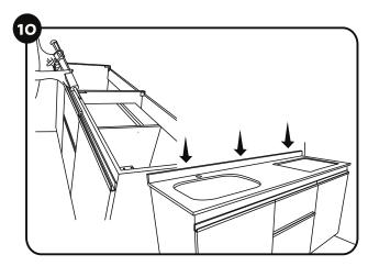
Se debe retirar el mesón antes de fijarlo con la silicona. Aplique silicona Anti-hongos por el contorno lateral y frontal del mueble como se muestra en la ilustración. Silicona Anti-hongos (NO INCLUIDA). Se instala el mesón tomando como guía la marcación realizada con el marcador borrable ,revise que el mesón ajuste completamente en todo el
