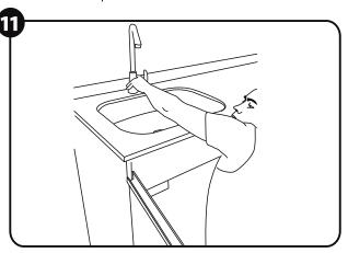
Instalación de la grifería de lavaplatos: La instalación de la grifería se debe realizar por la parte de abajo del mueble y se recomienda seguir las instrucciones del fabricante para una correcta instalación. Grifería NO incluida.
