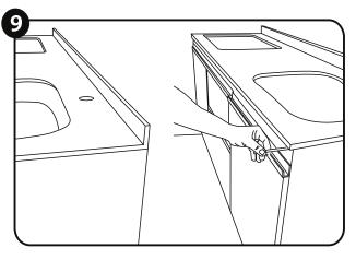
Revisar que en la parte de atrás el mesón debe quedar en el mismo perfil del mueble. En los laterales se debe guardar las mismas medidas en ambos lados, quedando el mesón debidamente centrado. La parte frontal debe quedar entre 1.5 a 2 cm sobresaliendo. Con un marcador borrable se traza por la parte inferior para demarcar donde debe quedar el mesón.
