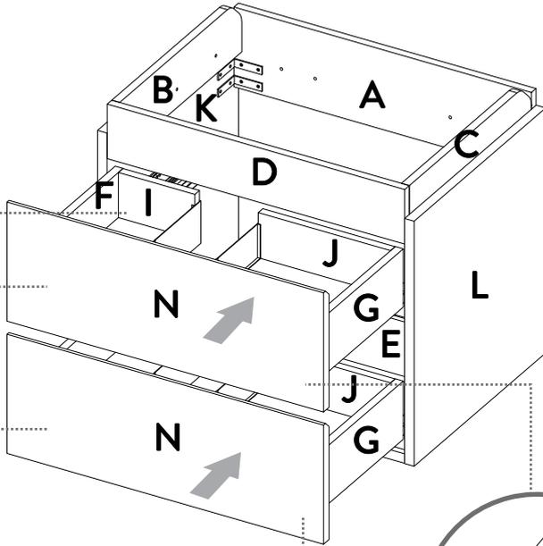
Asegurar el encaje del seguro plástico con el Riel en la parte frontal del cajón, como se muestra a continuación/ Make sure to fit the plastic lock with the Drawer Slide in the front of the drawer, as shown below.
