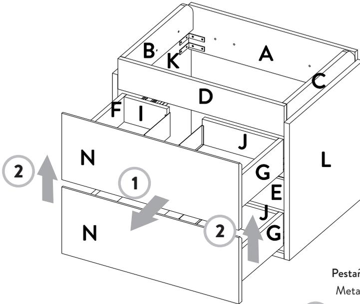
Asegúrese de soltar la pestaña metálica de los rieles desde la parte posterior del cajón como se muestra a continuación / Make sure to pull out each metallic eyelash of the drawer slides from the back of the drawers as shown below.
