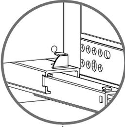
Asegúrese de que cada pestaña metálica de los rieles se introduzca en la perforación de la parte posterior del cajón como se muestra a continuación/
