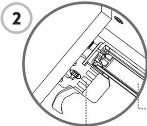
Separar el seguro plástico del riel en la parte frontal del cajón, como se muestra a continuación / Pull apart the plastic lock from the Drawer Slide in the front of the drawer, as shown below.
