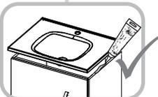
**SE RECOMIENDA aplicar silicona en el empalme entre el lavamanos y el mueble para evitar filtraciones de agua /** To avoid water leaks it is recommended to apply silicone between the cabinet and the sink.
