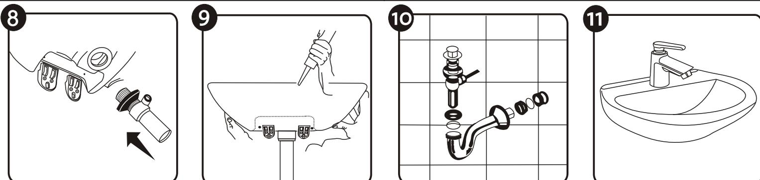
**8** Instale la línea de desagüe según las instrucciones del fabricante
