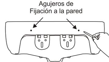
Con el lavamanos correctamente instalado y nivelado sobre las grapas, marque con un marcador borrable los agujeros de fijación a la pared y retire el lavamanos nuevamente. Realice las perforaciones en la pared terminada con un taladro manual, ubique los chazos plásticos dentro de las perforaciones realizadas.
