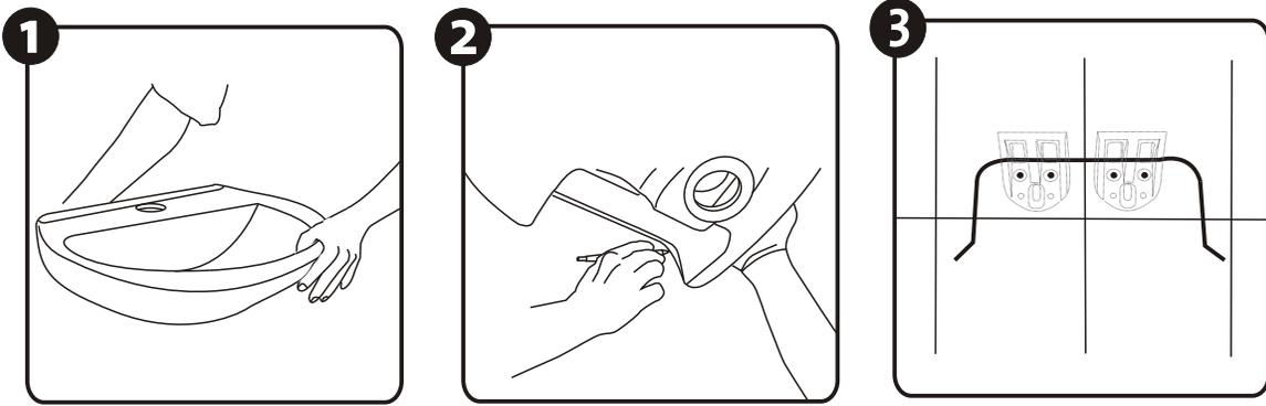
**1** Revise las condiciones de la superficie de instalación. Verifique que el piso y la pared se encuentren perpendiculares entre si y en óptimas condiciones de instalación. Ubique el lavamanos en posición de instalación
