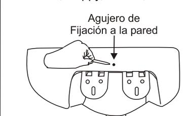
Con el lavamanos correctamente instalado y nivelado sobre las grapas, marque con un marcador borrable el agujero de fijación a la pared y retire el lavamanos nuevamente. Realice las perforaciones en la pared terminada con un taladro manual, ubique el chazo plástico dentro de la perforación realizada.
